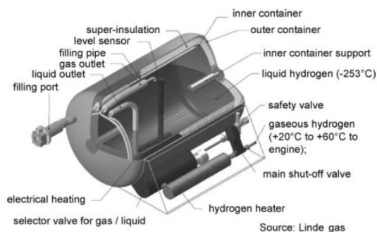
Σχήμα 5.5: Απεικόνιση του εσωτερικού μιας δεξαμενής υδρογόνου (Klell, 2010)
